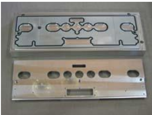
治具とワーク第一工程の面(ワークは完成品)
